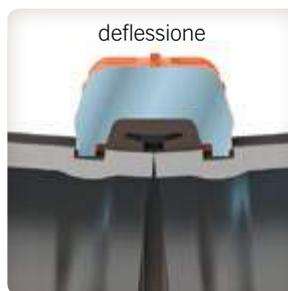
**Flessibilità** – con le proprietà intrinseche di deflessione e movimento assiale dei giunti flessibili in un sistema scanalato. Consente di assecondare la contrazione e l'espansione termica della tubazione, l'allineamento errato e l'assestamento, nonché l'assorbimento delle sollecitazioni sismiche.
